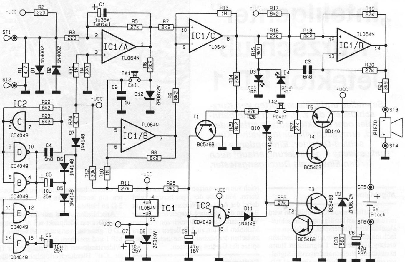
**Bild 2: Schaltbild des Kurzschluß-Detektors**
