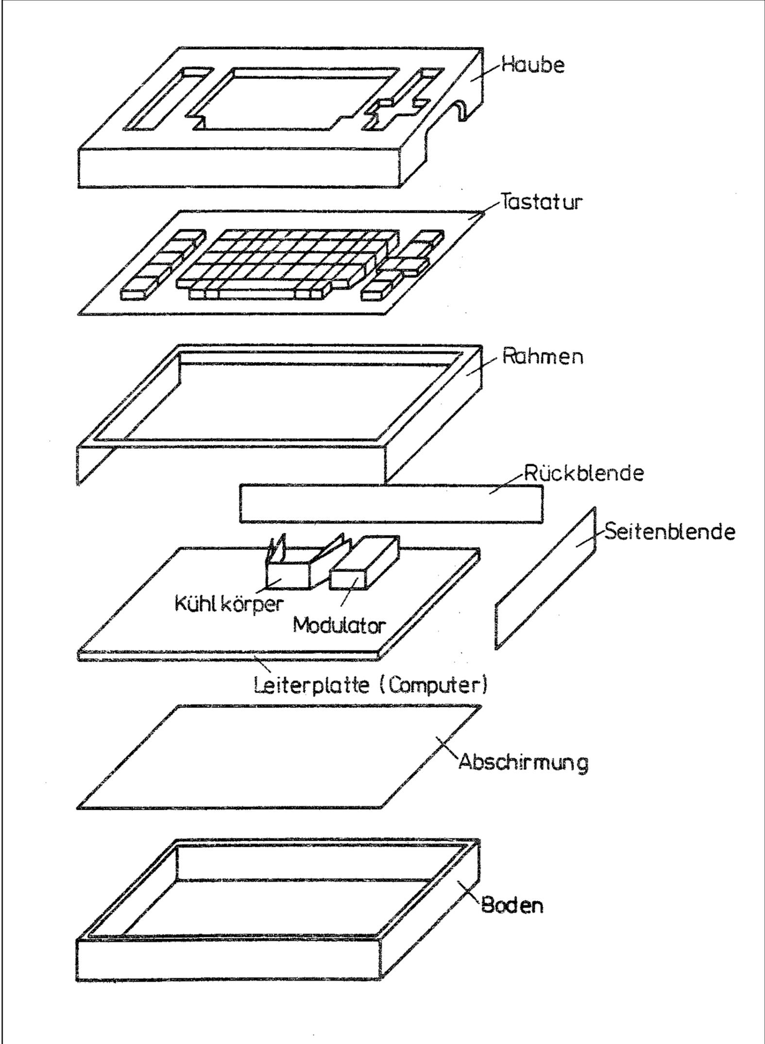
Bild 2.1 Mechanischer Aufbau des KCC - Grundgerätes
