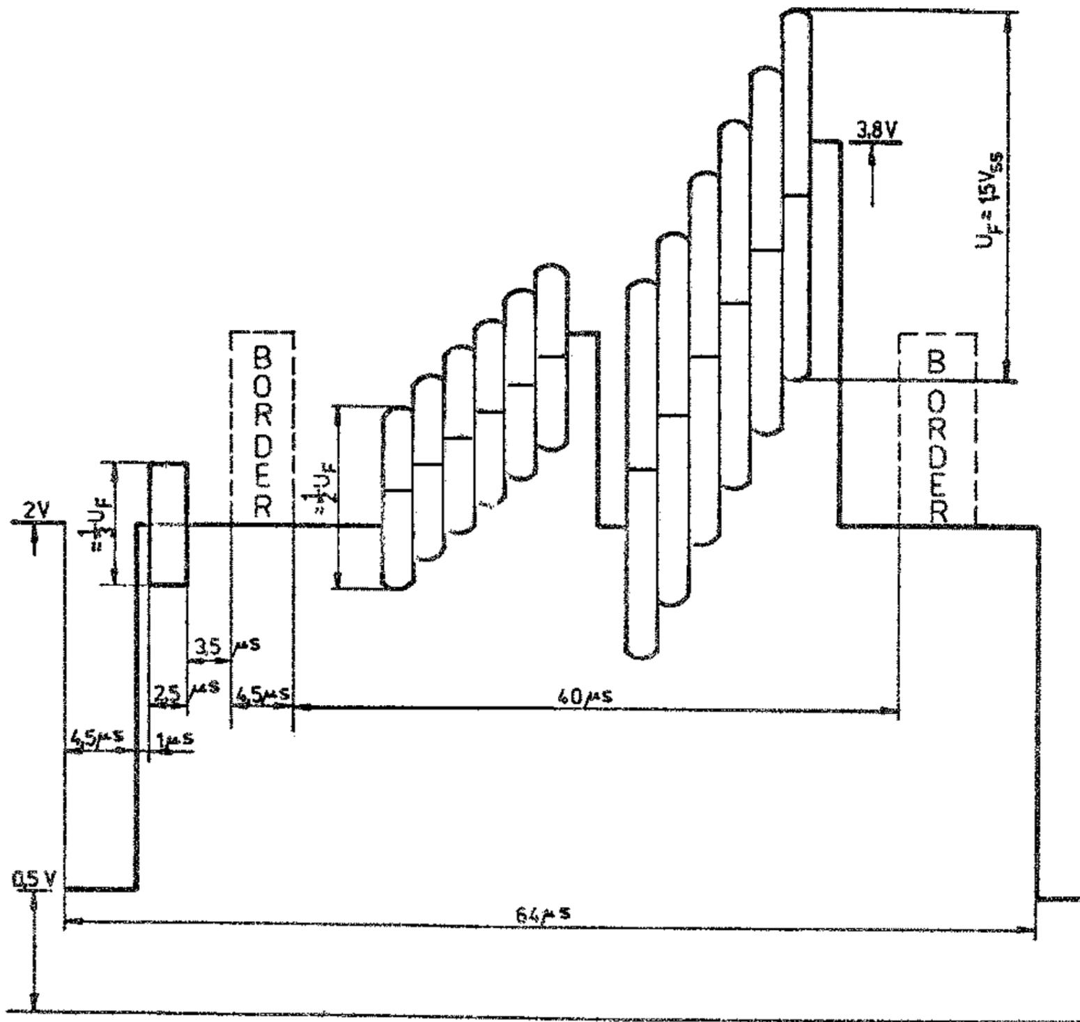
Bild 2.8 FBAS-Signal des KCC an X15 (Modulatoranschluß)
