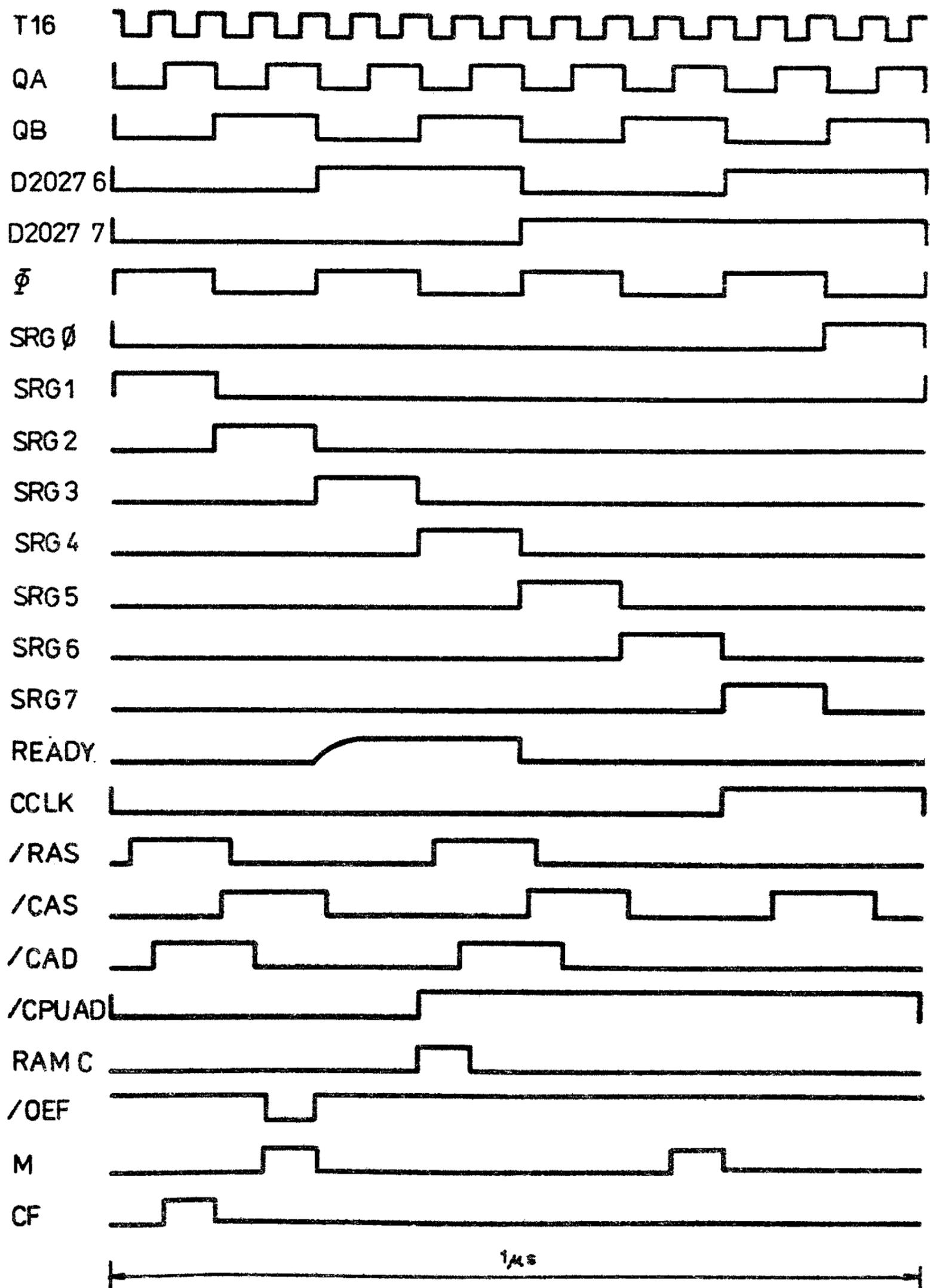
Bild 2.7 Taktsystem des KCC
