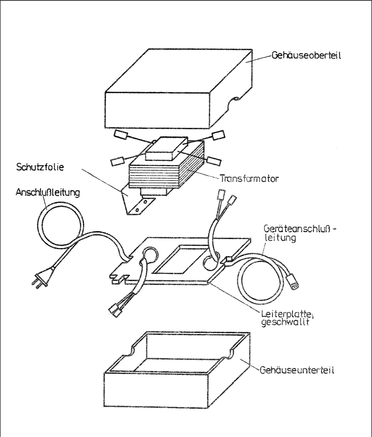
Bild 2.2 Mechanischer Aufbau des externen Netzteils
